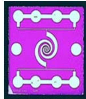
(그림 7) ETRI에서 제작한 안테나 집적 InGaAs SBD
